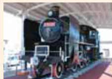
SL「C5692」 (出水駅前に展示) 1937(昭和12)年製。重量35トン、全長9.2メートル、高さ4メートルで72年の太陽国体で御召列車を引く大役を果たした。
